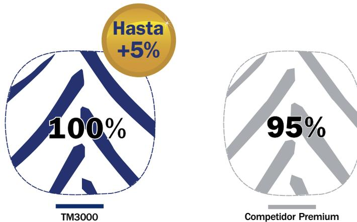
La mayor área de contacto del TM3000, reduce significativamente la compactación del suelo. El área de huella ancha proporciona mejores características de flotación que la competencia, respetando el suelo y preservando su vida orgánica, minimizando los daños mecánicos causados por la compresión.
